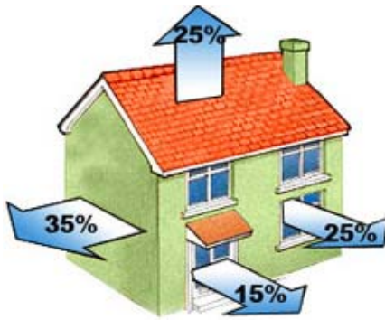
Binada ısı kaybı
