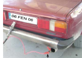
LPG dolumu sırasında topraklama
